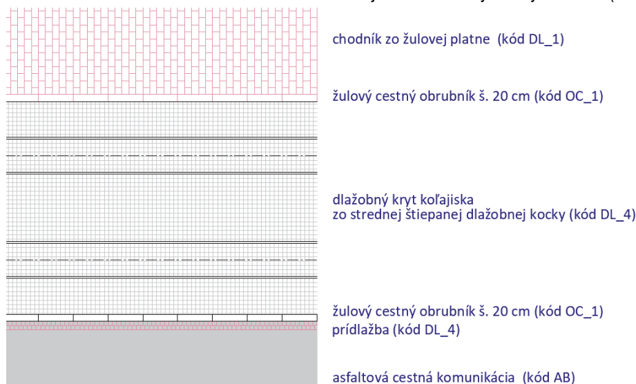
Obrázok 130_Pôdorysná schéma koľajiska – dlažbový kryt na Americkom námestí (táto schéma nenahrádza kladačský plán)
